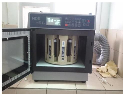
Gambar 2.2 Proses Dekstruksi Basah Tertutup
