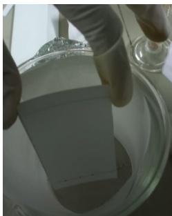
Proses pemasangan fase diam (plat klt)
