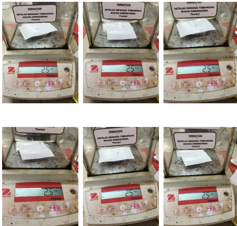
Penimbangan 2,5 mg baku standar natrium diklofenak untuk larutan spiked sampel
