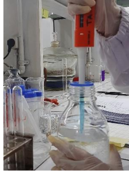
5. Mencampurkan 0,2 mL buffer natrium asetat (pH 4,5) 3 mL reagen GOPOD untuk blanko
