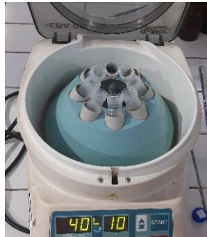
9. Disentrifus selama 10 menit pada 4000 rpm
