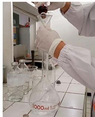
2. Buffer GOPOD Dituang ke Labu Ukur yang berisi Aquabidest
