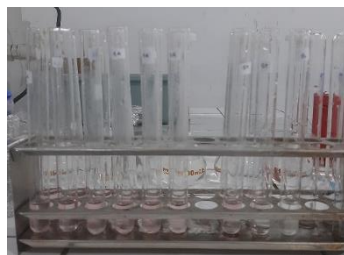
6. Mencampurkan 0,1 mL D-glukosa (botol 5); 0,1 mL buffer natrium asetat (pH 4,5); dan 3 mL reagen GOPOD untuk standar
