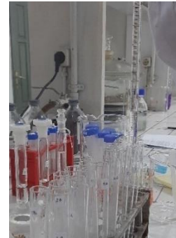
6. Mencampurkan 0,1 mL D-glukosa (botol 5); 0,1 mL buffer natrium asetat (pH 4,5); dan 3 mL reagen GOPOD untuk standar
