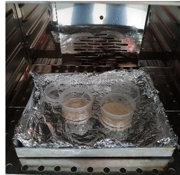
3. Proses pengeringan dalam oven bersuhu 105°C
