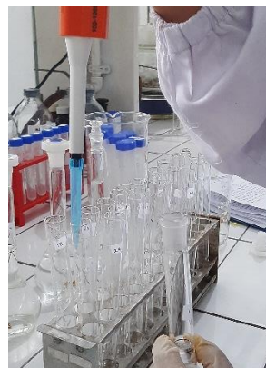
2. Dipindahkan 0,1 mL alikuot dari larutan tersebut ke tabung reaksi
