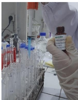
6. Mencampurkan 0,1 mL D-glukosa (botol 5); 0,1 mL buffer natrium asetat (pH 4,5); dan 3 mL reagen GOPOD untuk standar
