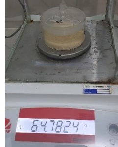
4. Proses pengeringan hingga memperoleh bobot tetap
