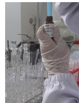
13. Mencampurkan 0,1 mL D-glukosa (botol 5) dan 3 mL reagen GOPOD untuk standar
