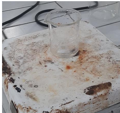
2. Melarutkan PAA/AMG dengan Magnetic Stirrer
