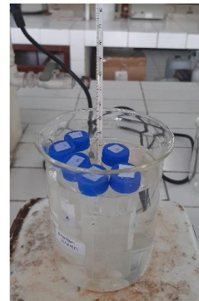
6. Dimasukkan ke waterbath bersuhu 50°C
