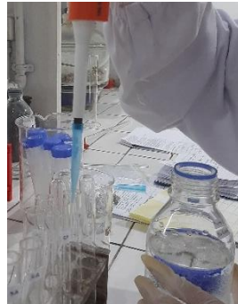
6. Mencampurkan 0,1 mL D-glukosa (botol 5); 0,1 mL buffer natrium asetat (pH 4,5); dan 3 mL reagen GOPOD untuk standar
