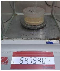
4. Proses pengeringan hingga memperoleh bobot tetap
