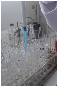
12. Mencampurkan 0,1 mL buffer natrium asetat (pH 4,5) & 3 mL reagen GOPOD untuk blanko
