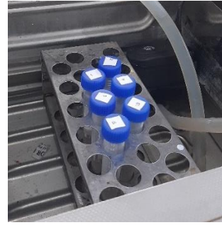
4. Diinkubasi selama 5 Menit pada suhu 37°C
