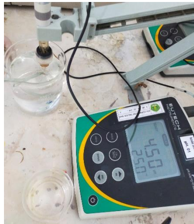
2. Atur hingga pH 4,5 dengan Menambahkan NaOH 1 M
