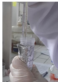
13. Mencampurkan 0,1 mL D-glukosa (botol 5) dan 3 mL reagen GOPOD untuk standar
