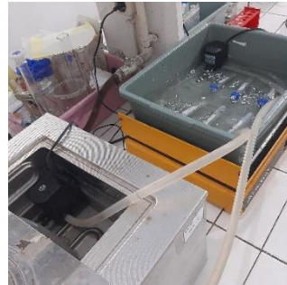
6. Inkubasi pada Shaking Waterbath selama 4 jam suhu 37°C
