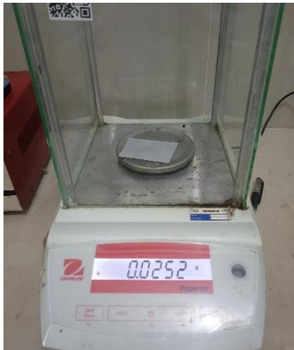
Penimbangan padatan  $\text{Cd}(\text{NO}_3)_2$  untuk pembuatan kontrol positif (+)
