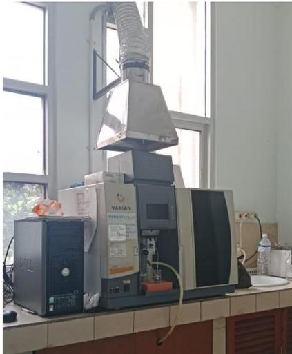
Instrument Spektrofotometri Serapan Atom (SSA)
