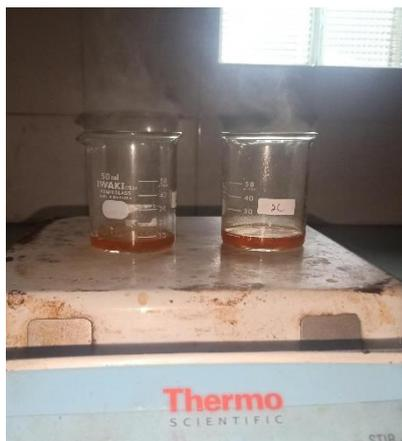
Proses destruksi larutan sampel kerang hijau dengan *hot plate*
