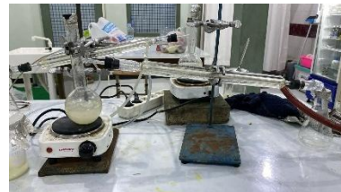
Destilasi sampel pada proses pengujian kuantitatif kadar senyawa sianida
