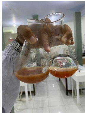
Titik akhir titrasi pada pembakuan titran \text{AgNO}_3
