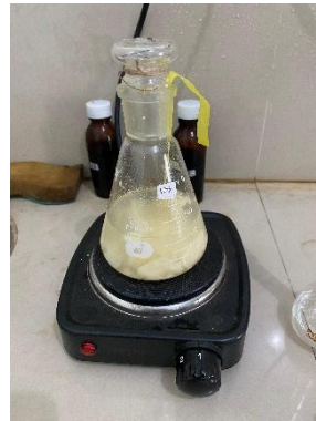
Proses pemanasan pada uji kualitatif deteksi sianida
