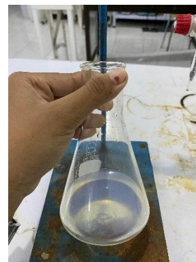
Titik akhir titrasi pada filtrat yang telah dititrasi dengan larutan \text{AgNO}_3
