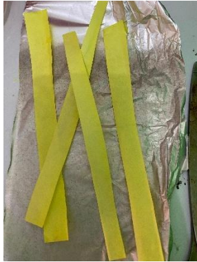
Pembuatan Kertas pikrat untuk uji kualitatif sianida
