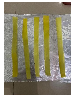
Tidak adanya perubahan warna pada kertas pikrat setelah proses pemanasan menunjukkan sampel negatif sianida
