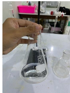
Air suling digunakan untuk pembakuan titran \text{AgNO}_3
