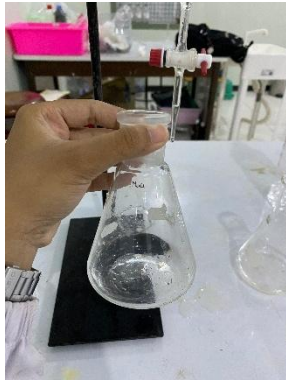
Larutan NaCl digunakan untuk pembakuan titran \text{AgNO}_3
