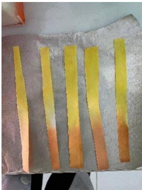
Perubahan warna kertas pikrat setelah proses pemanasan menunjukkan sampel positif sianida
